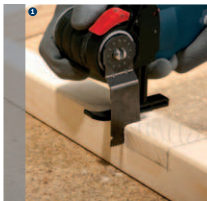
1 Tagli dal pieno precisi nel legno, ades. per tagliare legno da costruzione
