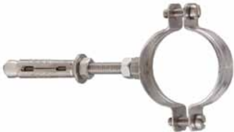
CAV INOX A2 collare INOX A2 con tassello TOP INOX A2 e dado saldato per tubazioni e canne fumarie
