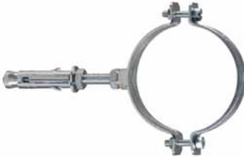
CAV collare in acciaio con tassello AV, dado saldato e doppia vite laterale per tubi di scarico e canne fumarie
