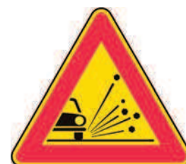
Figura II 390 MATERIALE INSTABILE SULLA STRADA
