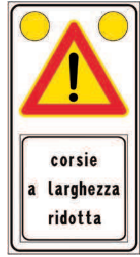
Figura II 391/c CORSIE A LARGHEZZA RIDOTTA Presegnala un tratto di strada nel quale la/e corsia/e è/sono di larghezza ridotta.
