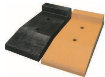
Figura 481 ROTATORIA Realizzata con una prevalenza di materiale riciclato (come previsto dal Decreto 8 maggio 2003, n.203), sono costituite da elementi da fissare a terra che consentono di creare rotatorie adatte ad ogni dimensione di incrocio. Moduli da cm. 47,1x28,63x100 e da cm. 47,1x39x3x100.
