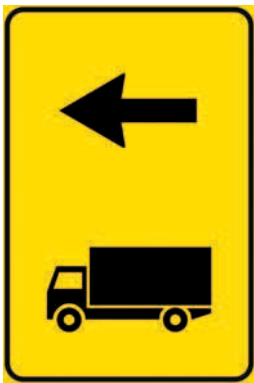
Figura II 410/b DIREZIONE AUTOCARRI CONSIGLIATA Segnala, in avvicinamento ad un cantiere stradale, la direzione consigliata per i veicoli di trasporto di cose di massa complessiva superiore a 3,5 t.
