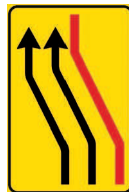
Figura II 412/e SEGNALE DI RIENTRO IN CARREGGIATA Indica il rientro nella carreggiata normale di marcia.
