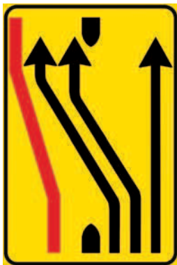
Figura II 411/g SEGNALE DI CORSIE CHIUSE Indica la possibilità di proseguire dritto o su una delle corsie della carreggiata opposta per la presenza di una deviazione in corrispondenza di un cantiere stradale.
