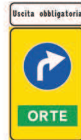
Figura II 80/f PREAVVISO DI DIREZIONE OBBLIGATORIA A DESTRA Preavvisa l'obbligo di voltare a destra.
