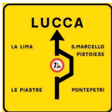
Figura II 408 PREAVVISO DI DEVIAZIONE Esemplifica una limitazione di transito lungo un tronco di strada, vietandolo ai veicoli aventi una massa totale superiore a 7,0 t, ed indica l'itinerario alternativo percorribile da parte di tali veicoli.
