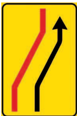
Figura II 412/c SEGNALE DI RIENTRO IN CARREGGIATA Indica la chiusura della carreggiata con conseguente deviazione su una corsia della carreggiata opposta oppure sulla eventuale corsia di emergenza.
