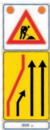
Figura II 399/a PRESEGNALE DI CANTIERE MOBILE È disposto sulla banchina o sulla corsia di emergenza e spostato in avanti in maniera coordinata all'avanzamento dei lavori. Può essere installato anche su un veicolo a copertura e protezione anticipata e comunque ad una distanza che consenta ai conducenti una normale manovra di decelerazione in relazione alla velocità prevalente sulla tratta di strada. Il segnale di corsie disponibili inserito è quello di Figura II 411/a o Figura II 411/b secondo la necessità.
