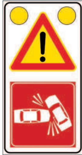
Figura II 391/a INCIDENTE Presegnala un pericolo dovuto alla presenza di un incidente stradale.
