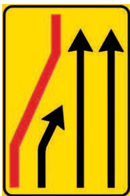
Figura II 411/b SX SEGNALE DI CORSIA CHIUSA (CHIUSURA CORSIA DI SINISTRA) Indica la riduzione da tre a due corsie di marcia per la presenza di una deviazione in corrispondenza di un cantiere stradale.
