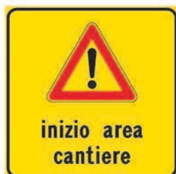
Figura 529 INIZIO AREA CANTIERE
