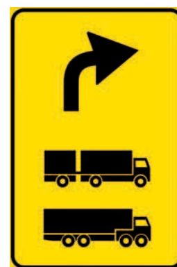
Figura II 410/a PREAVVISO DEVIAZIONE AUTOCARRI CONSIGLIATA Presegnala, in avvicinamento ad un cantiere stradale, l'esistenza di un itinerario consigliato per autotreni ed autoarticolati.
