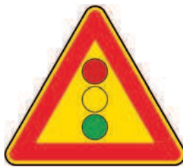
Figura II 404 SEMAFORO Presegnala un impianto semaforico.
