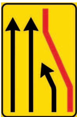
Figura II 411/b DX SEGNALE DI CORSIA CHIUSA (CHIUSURA CORSIA DI DESTRA) Indica la riduzione da tre a due corsie di marcia per la presenza di una deviazione in corrispondenza di un cantiere stradale.
