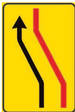
Figura II 412/d SEGNALE DI RIENTRO IN CARREGGIATA Indica il rientro nella carreggiata normale di marcia.
