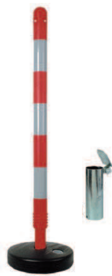
Figura 754/a PALETTO PER BY-PASS Palina flessibile h. cm. 115 realizzata in materiale plastico colore rosso con soffiato per BY-PASS con innesto a baionetta.
