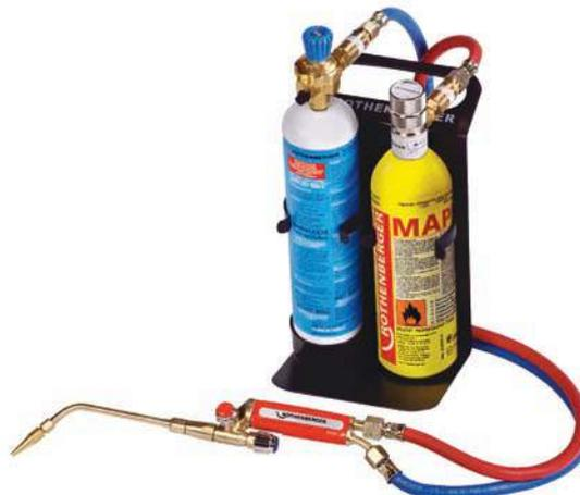
Il Set (No. 1000000558) comprende: cartuccia MAPP GAS, bombola ossigeno 110 bar, telaio di supporto con portabombole, valvola di regolazione, regolatore di pressione costante, impugnatura di sicurezza con valvola di non ritorno, ugello di miscelazione con dado, 1 ugello di saldatura ad alte prestazioni con dado Ø 0,9 mm, 4 bruciatori micro Ø 0,3-0,7 mm, 1 adattatore micro per ugelli, 1 occhiali di protezione A5 secondo DIN, accendino di sicurezza, 1 chiave
