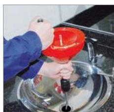
**Dispositivo di bloccaggio spirale, con spirale flessibile a punta conica**
