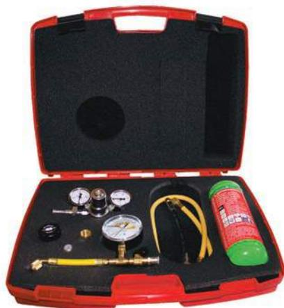
Il set (No. R25900616) comprende: bombola di azoto da 1 Lt, adattatore 5/16" per R410A, attacco 1/4" SAE, manometro diam. 80 classe 1, tubo flessibile 1/4" SAE 900 mm, valigetta di trasporto.
