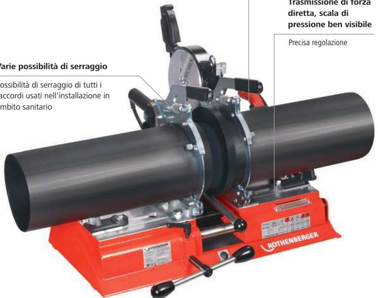
Il set (No. 54000) comprende: macchina base con fresa elettrica, dispositivo di fresatura per derivazioni a 45°, termoelemento teflonato con regolazione elettronica e dispositivo di protezione da contatti e per il trasporto, serie morse base destra e sinistra Ø 160 mm (No. 54082), supporto tubo base Ø 160 mm, serie riduzioni e supporti laterali tubo da Ø 40, 50, 63, 75, 90, 110 e 125 mm in cassetta di metallo (No. 54020), chiavi di servizio, supporto carrello di lavoro e di trasporto (No. 54015)
