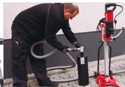
Dispositivo di scorrimento che consente una rapida sostituzione del motore
