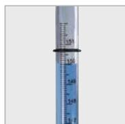
Scala di misurazione da 146,5 mbar fino a 153,5 mbar con punto nullo a 150 mbar su tubicino di prolunga trasparente ad innesto.
